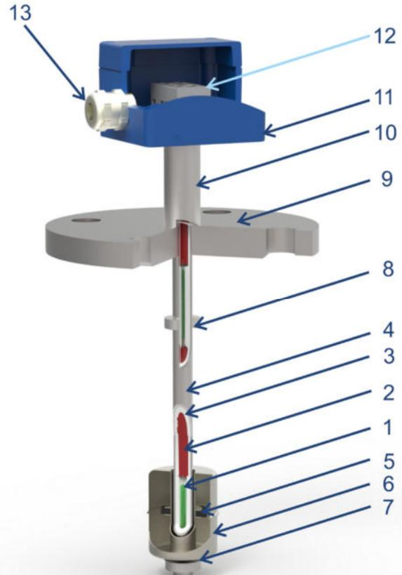
Рисунок 1.1 Устройство сигнализатора уровня LLS-F-T
