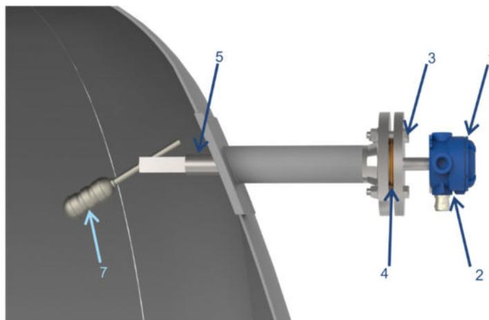
Рисунок 3.2 Монтаж сигнализатора горизонтального исполнения.
