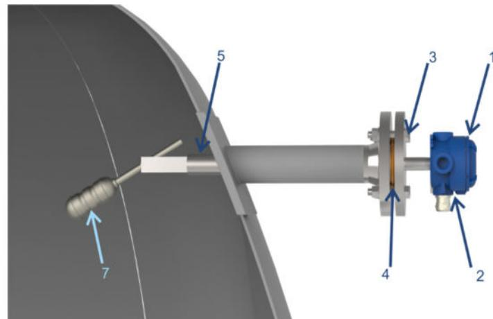
Рисунок 3.2 Монтаж сигнализатора горизонтального исполнения.
